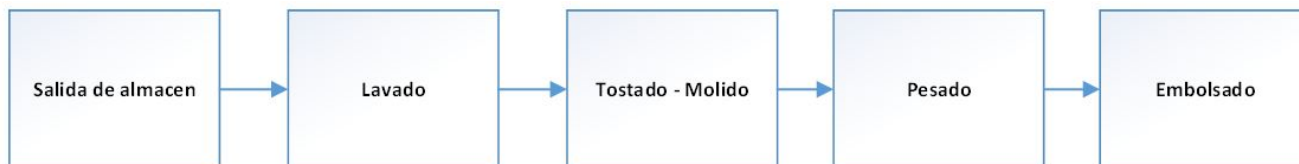
Figura 32 – Proceso de transformación de grano de cañahua de APPOA
