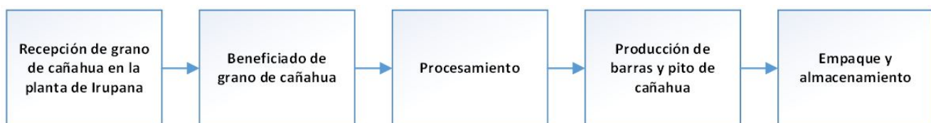
Figura 24 – Proceso de transformación de grano de cañahua de Industrias Irupana Andean Organic Food S.A.
