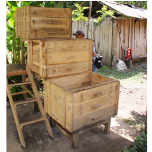
Ilustración 20. Cajones fermentadores en escalera.
